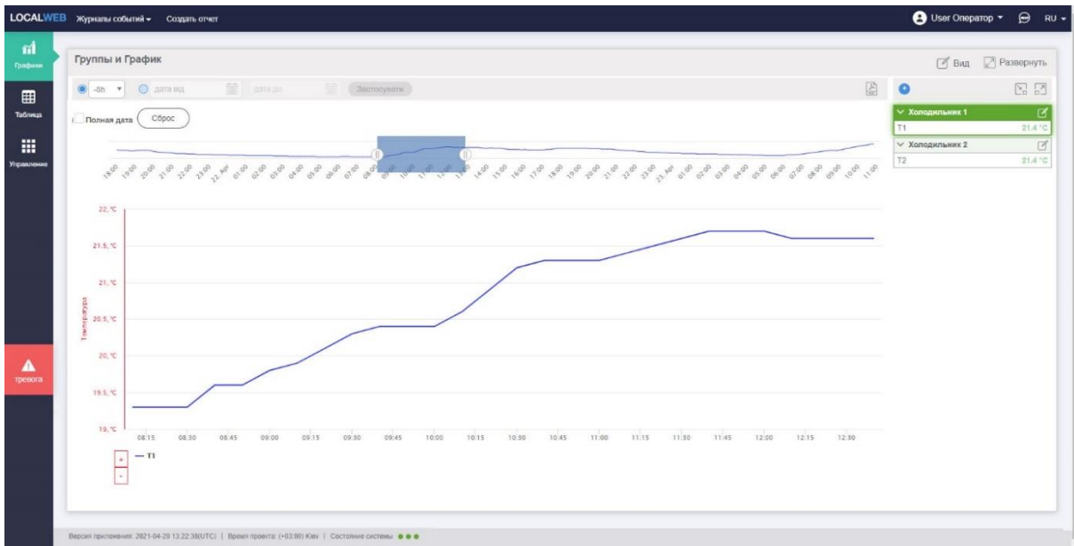
Рисунок 16. Выделение части временного интервала с помощью линии тренда
