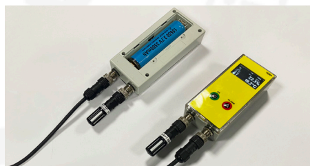
Locația bateriei în logger
