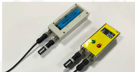
Platzierung des Akkus im Logger
